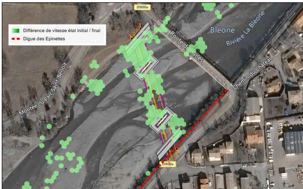
Figure 35 : Localisation des augmentations de vitesses d'écoulement vis de vis de la digue des Epinettes
