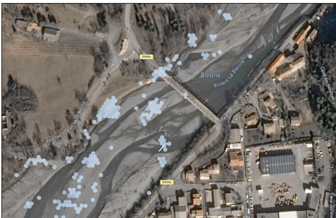
Figure 33 : Localisation des augmentations de hauteurs d'eau entre l'état initial et l'état projet
