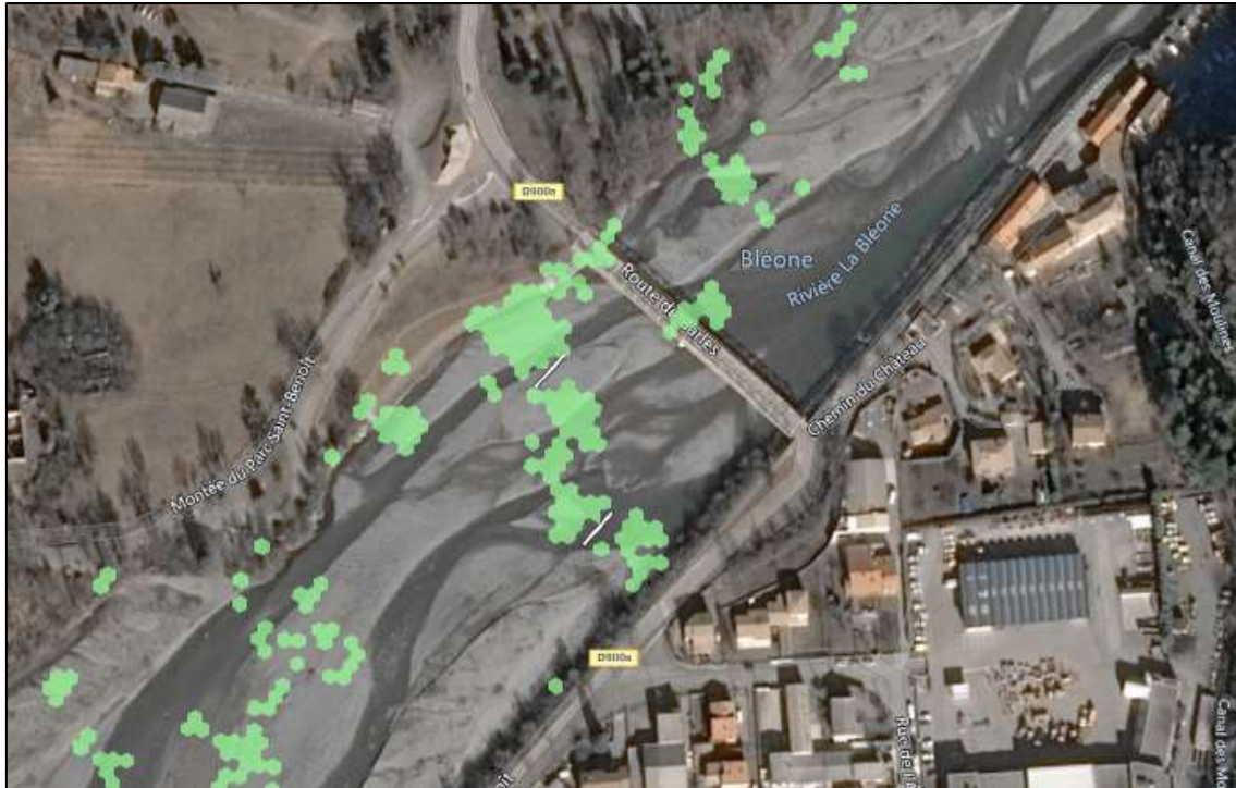
Figure 34 : Localisation des augmentations de vitesses d'écoulement entre l'état initial et l'état projet
